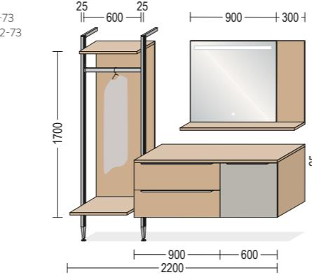
2x HRS 30-1 Colonnettes en aluminium en hauteur d'armoire 1, p : 295 mm
